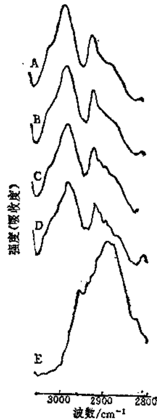
图 3-78 (A~D)在各种光学速度下测得的表面处理后的PET的光声光谱 (A) 0.235\text{cm}\cdot\text{s}^{-1} ; (B) 0.385\text{cm}\cdot\text{s}^{-1} ; (C) 0.665\text{cm}\cdot\text{s}^{-1} ; (D) 1.119\text{cm}\cdot\text{s}^{-1} ; (E)表面处理剂的光声光谱
